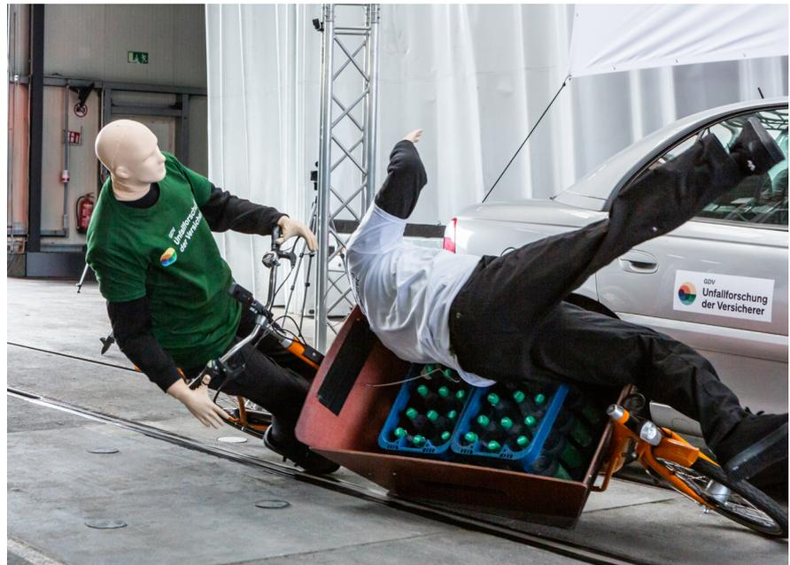
Abbildung 3: Simulation einer Kollision eines Lastenfahrads mit einer zu Fuß gehenden Person
