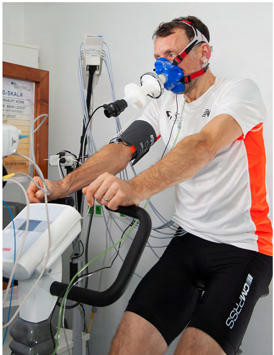
Abbildung 2: Proband auf dem Fahrradergometer mit der speziell entwickelten Atemmaske zur Untersuchung der Belastung von Lunge, Herz und Kreislauf bei unterschiedlichen körperlichen Anstrengungen.
