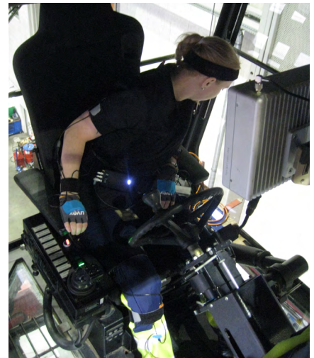
Abbildung 4: Analyse von Körperhaltung und Ganzkörpervibration im Van Carrier
