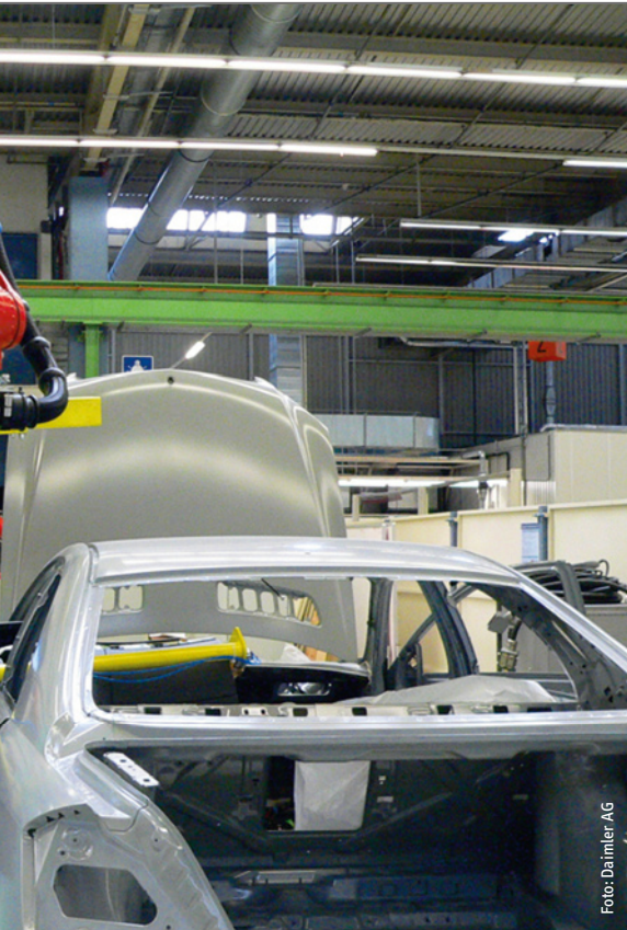
Bei der Armaturenbrettmontage im Fahrzeugbau arbeiten Mensch und Roboter eng zusammen
