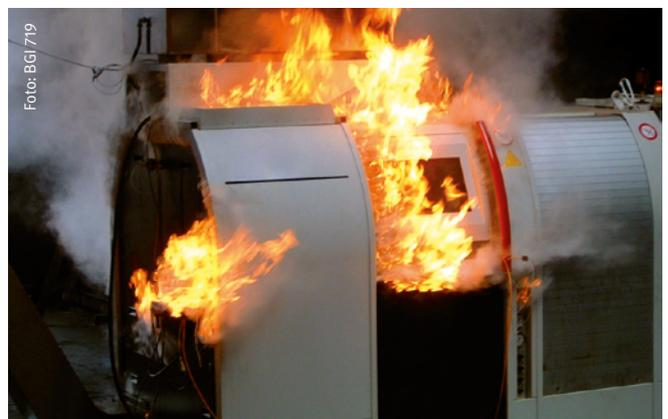
Flammeustritt im Türbereich bei einer Verpuffung bei ungünstiger Labyrinthgeometrie
