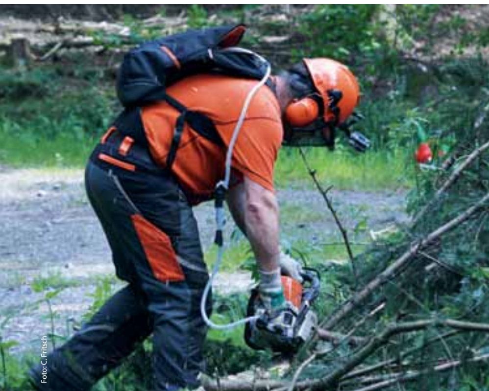
Messung der Hand-Arm-Vibrationen beim Entasten eines gefällten Baumes
