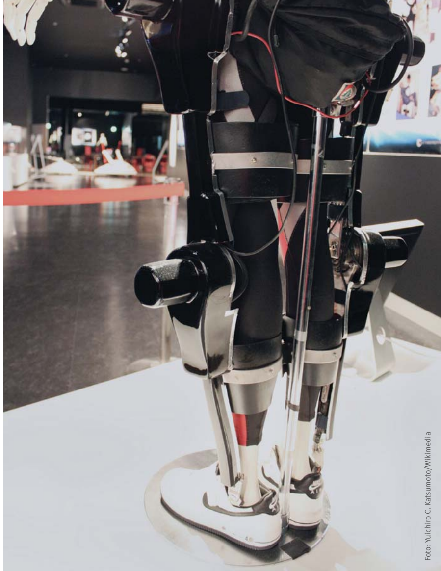
Das Hybrid Assistive Limb (HAL) der japanischen Firma Cyberdyne zählt zu den aktiven Exoskeletten, die über elektrische oder pneumatische Antriebe verfügen.
